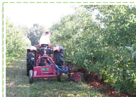
Passage du système à disques pour la gestion de l'herbe sur le rang
