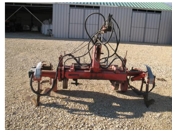
Bineuse de la marque Pellenc équipée de coutre. Crédit photo : Ctifl
