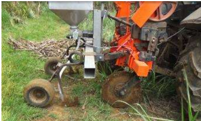
Figures 4 & 5 : Semoirs à disques utilisés pour les semis de grosses graines comme C. ensiformis sur M2 (à gauche) et du mélange de petites graines sur M3 (à droite).
