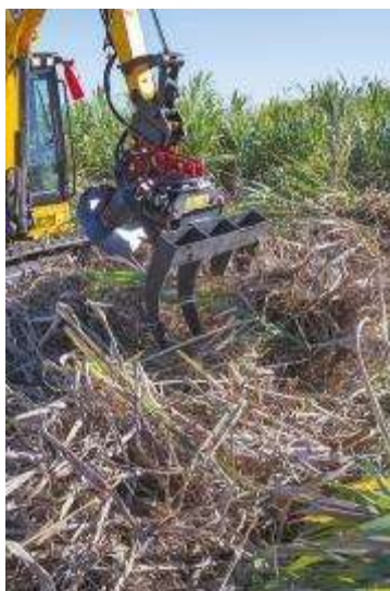
Figure 37 : Tête de coupe d'une coupeuse péi avec un peigne d'épillage
