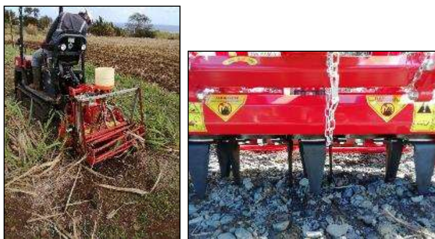
Figure 19 & 20 : Rotofraise attelée au microtracteur (à gauche), dents de la rotofraise (à droite)
