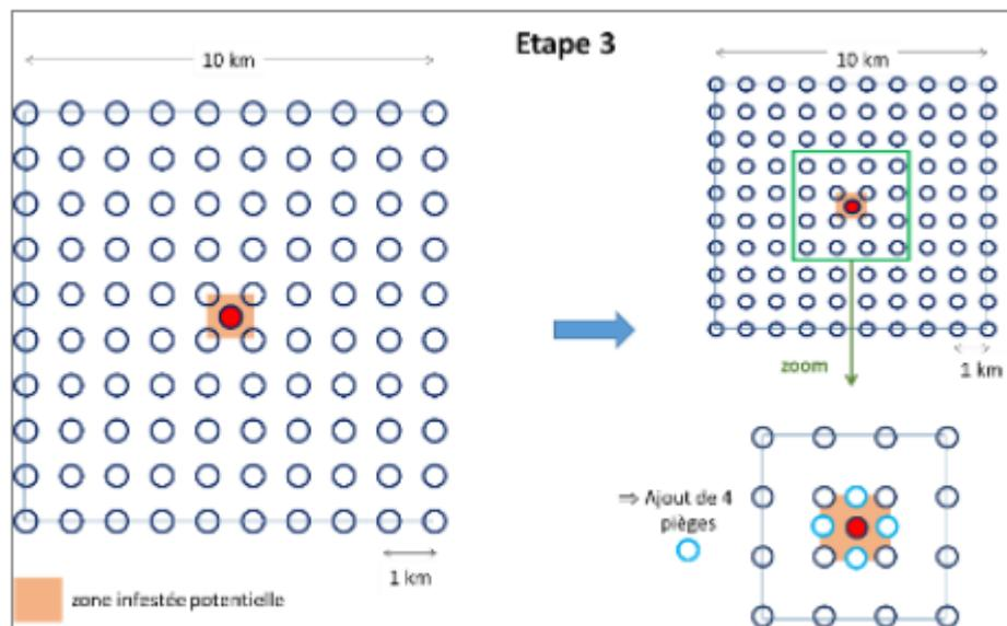
Figure 28. Recentreage du réseau de piégeage
