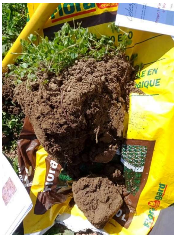
Figure 10 - Photo du bloc de terre analysé avec le test bêche aux Jardins de Canabera (Source personnelle)
