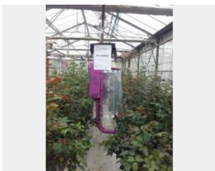
Lutte physique avec robot d'aspiration des arthropodes des strates végétales.jpg
