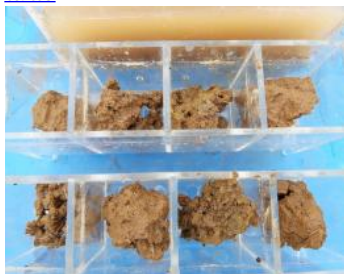
Test de stabilité structurale
