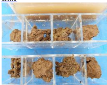
Test de stabilité structurale
