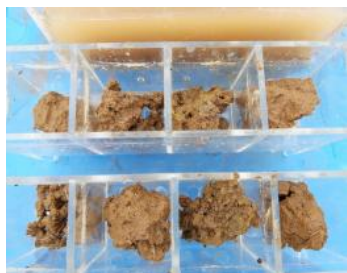
Test de stabilité structurale
