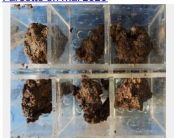
Test de stabilité structurale du sol
