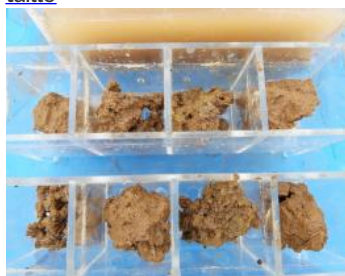
Test de stabilité structurale
