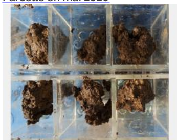
Test de stabilité structurale du sol
