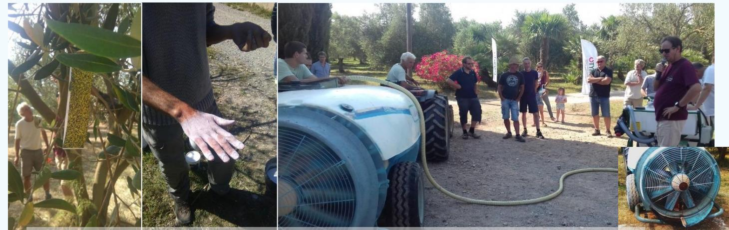
Légende : Le réglage du pulvérisateur, le dosage et la préparation de la bouillie ainsi que l'entretien de la machine sont facteurs de réussite.
