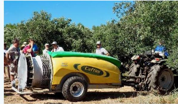
Pour une pulvérisation optimale : choisir un pulvé à piston-membrane adapté à l'utilisation des barrières minérales et à la forme des arbres.
