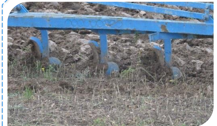
Labour léger pour diminuer la pression bioagresseurs du sol. Crédit photo : EPLEFPA de Toulouse
