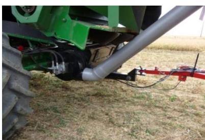
Bac d'extraction et remorque de récupération des menues pailles
